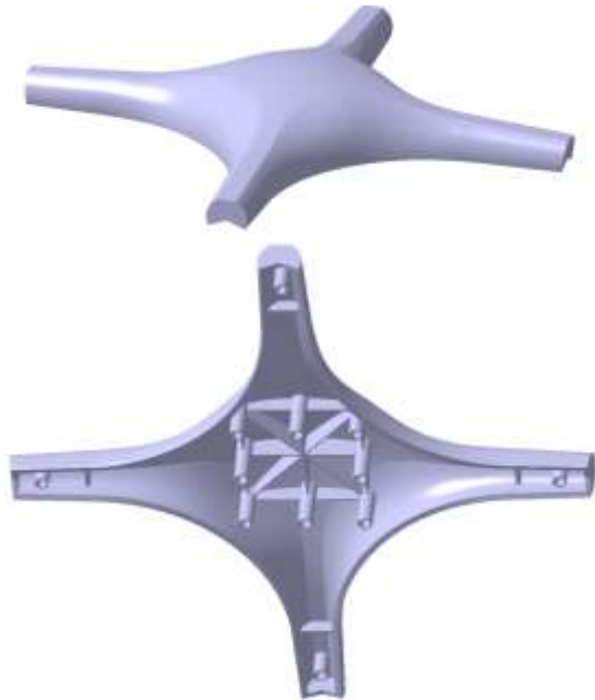
Figura 1.- Geometría de la pieza de plástico objeto de estudio. Fuente: elaboración propia
