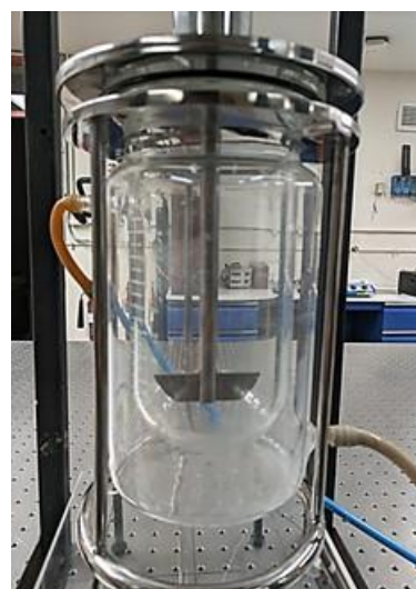
Figura 2. Dispositivo aprobado por la USP (USP 2).
