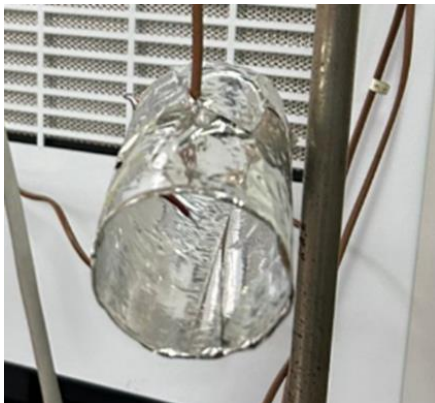
Figura 5. Instalación de termopar para medición de temperatura ambiente.
