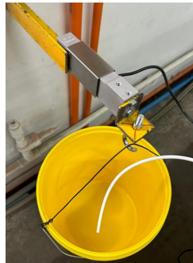
Figura 6. Instalación de sensor de fuerza para medición de masa de agua captada.
