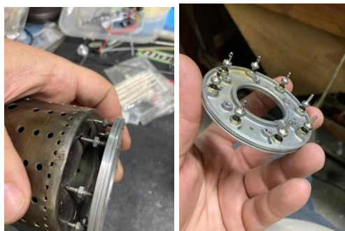
Figura 13. Nuevos inyectores montados en la cámara de combustión con su nueva disposición
