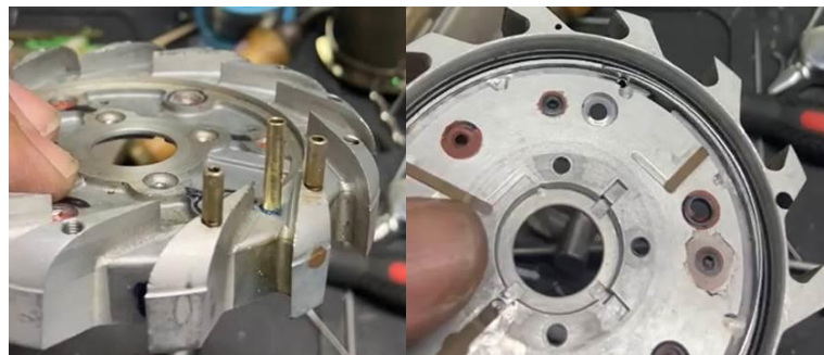
Figura 16. Nuevo tubing de inyección directa al anillo de distribución (central)
