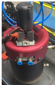
Figura 9. Nueva pieza con conexiones FESTO para la entrada de H 2 a la turbina
