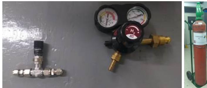
Figura 7. De izquierda a derecha, válvulas reguladoras de caudal y presión y Cilindro de hidrogeno.
