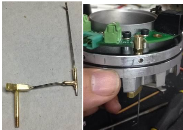
Figura 4. Nueva cañería de lubricación y montaje
