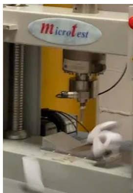
Figura 16. Momento de rotura de Pie 2.
