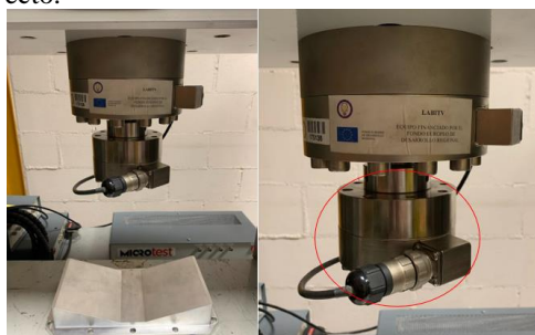
Figura 9. Área de ensayo y célula de carga.
