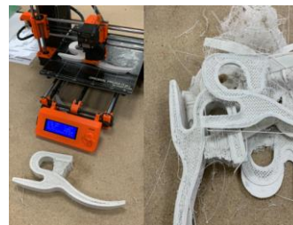
Figura 14. Intentos de impresión fallidos Pie 11.
