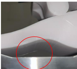
Figura 15. Fisuras tras la carga de prueba en Pie 2.
