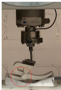
Figura 19. Momento de rotura de Pie 11.
