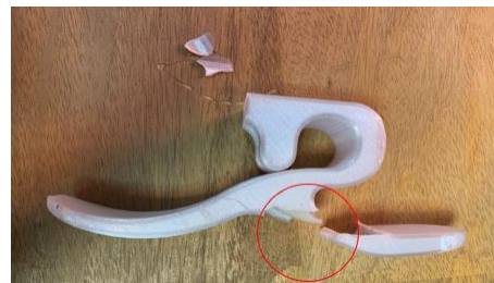
Figura 17. Detalle de la rotura del Pie 8.
