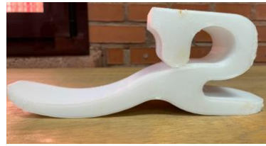
Figura 12. Pie 9 Multimaterial de PETG y PLA.
