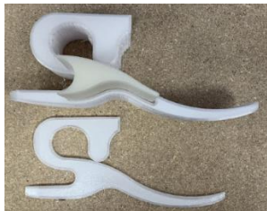
Figura 11. Pie 8-Núcleo-carcasa de PETG y PLA.
