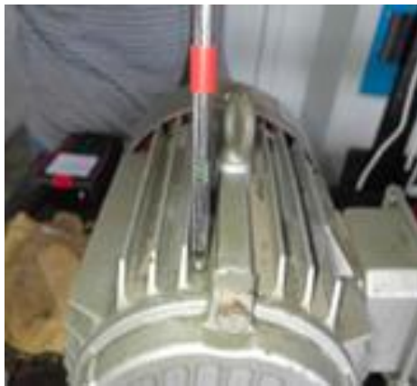
Figura 4. Toma de muestras con anemómetro Gm8903 Fuente: Elaboración propia.
