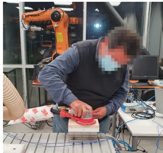
Figura 1: operación de lijado manual en laboratorio. Fuente: elaboración propia.
