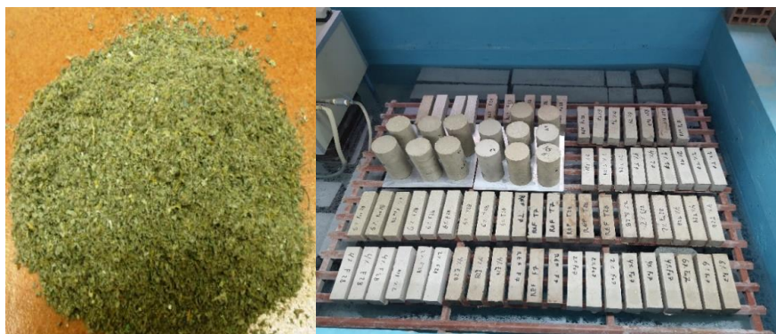
Figura 1: Residuos plásticos Agregados finos y muestras fundidas de agregados plásticos
