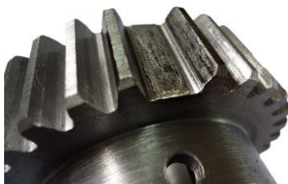
Figura 2. Fallo de rotura P10
