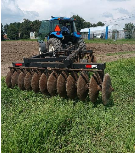
Figura 1. Conjunto tractor NH TS6.110 y, rastra de 24 discos equipado con sistema de guiado.
