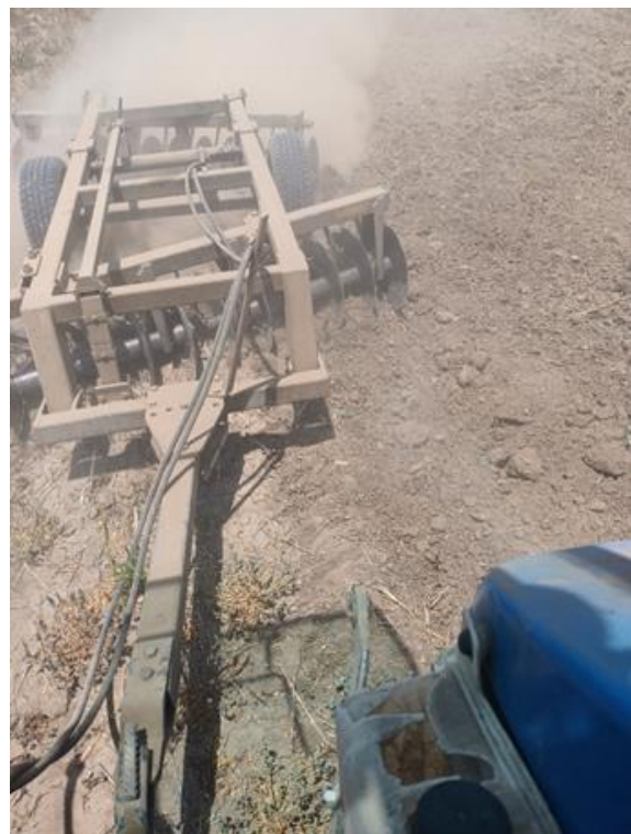
Figura 7. Rastra de 24 discos trabajando sin traslape.
