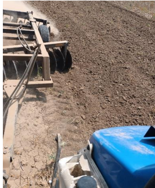
Figura 6. Rastra de 24 discos trabajando con un traslape de 10 %.
