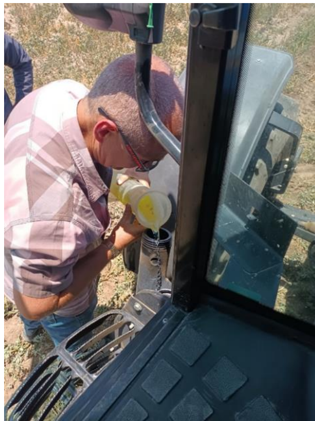
Figura 8. Medición del consumo de combustible empleando el método de aforo.
