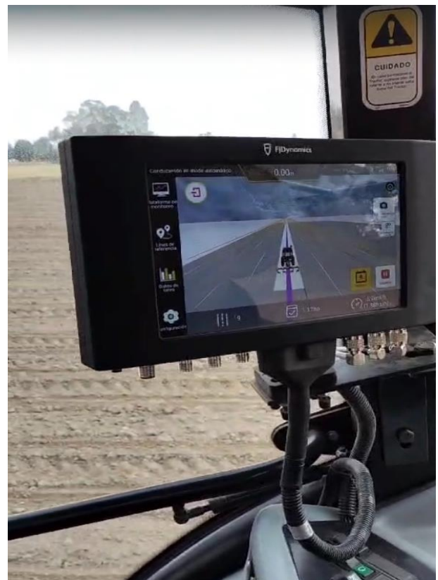
Figura 4. Terminal de control del sistema de dirección automática FJD Autosteering.
