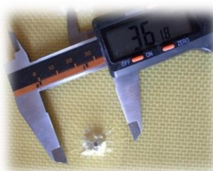
Figura 17 Impactos balísticos placa A04 parte trasera Fractura de matriz Fuente: Autor.
