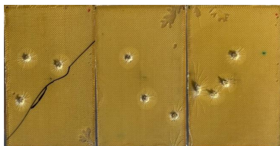
Figura 16 Impacto balístico Placa A 02, 04, 05 vista posterior Fuente: Autor.
