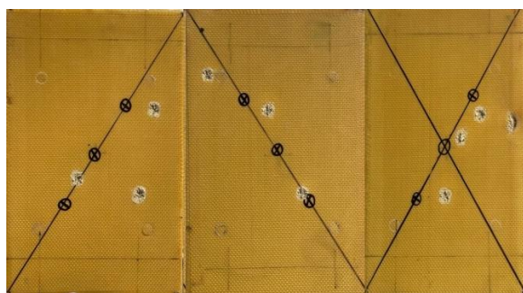
Figura 15 Impacto balístico Placa A 02, 04, 05 vista frontal Fuente: Autor.
