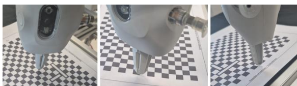
Figura 12. Posicionamiento de la herramienta en las referencias del espacio de trabajo, centro, extremo en X y extremo en Y respectivamente.
