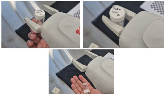
Figura 17. Pruebas físicas del gripper en recolección y liberación del objeto.
