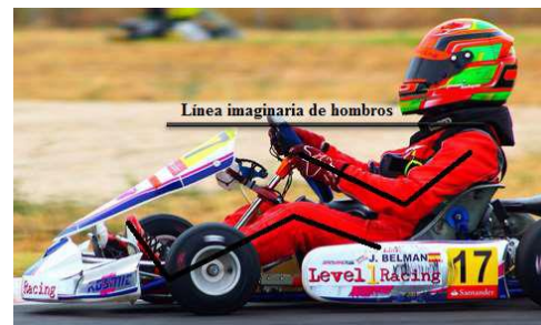
Figura 9. Posición y altura de las manos en el volante de un kart – inclinación de asiento – Posición de conducción. Fuente: Autores.
