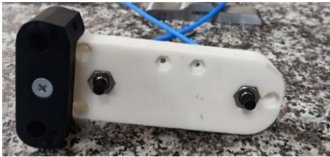
Figura 9. Base porta sensores proximiores. Fuente: Autores.
