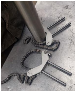
Figura 10. Soporte triangular y cadena de sujeción. Fuente: Autores.
