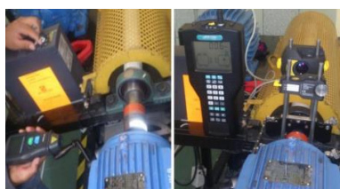
Figura 3. Alineamiento de ejes por sistema láser [11].
