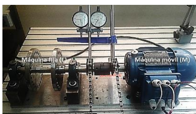
Figura 4. Montaje de los dispositivos de alineación [9].
