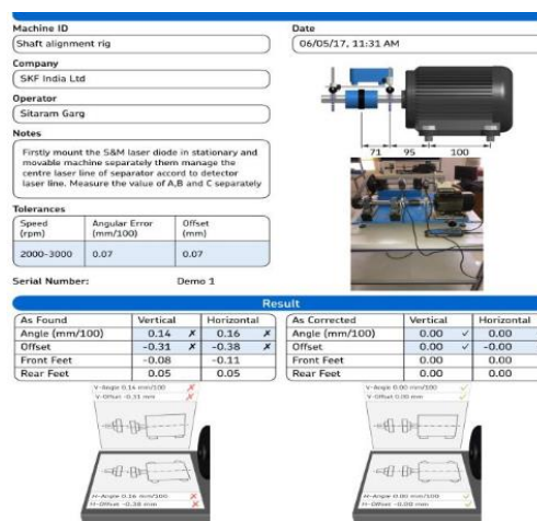
Figura 5. Informe de alineación de ejes diseñado mediante Software [12].
