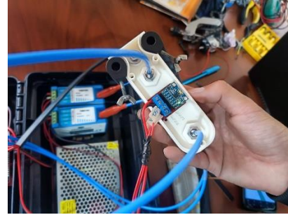
Figura 15. Instalación de giroscopio y conexión a drivers.
