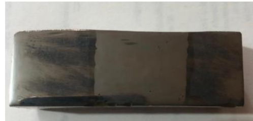
Figura 11. Muestra de soldadura E7018 después del ataque químico. Fuente del Autor
