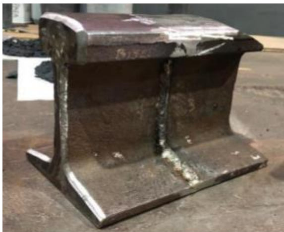
Figura 7. Pasadas de soldadura y esmerilado en probetas.
