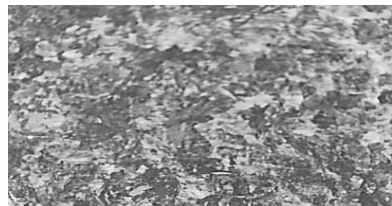
Figura 22. Metalografía tomada del metal base que muestra Cementita en un acero hipereutectoide que se calentó y láminas de perlit. El calentamiento posterior permitió que el material minimizara su estado energético. Ataque químico nital al 2%. Aumento original X100.
