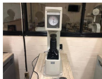
Figura 13. Durómetro Mitutoyo AR-20®
