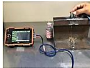
Figura 16. Detección de discontinuidades
