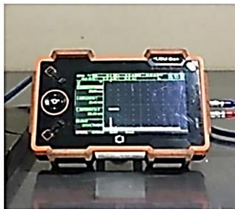
Figura 8. Equipo de medición de espesores y detección de fallas por UT. Fuente del autor.
