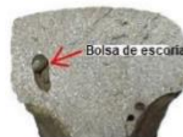
Figura 2. Falla en una soldadura aluminotérmica
