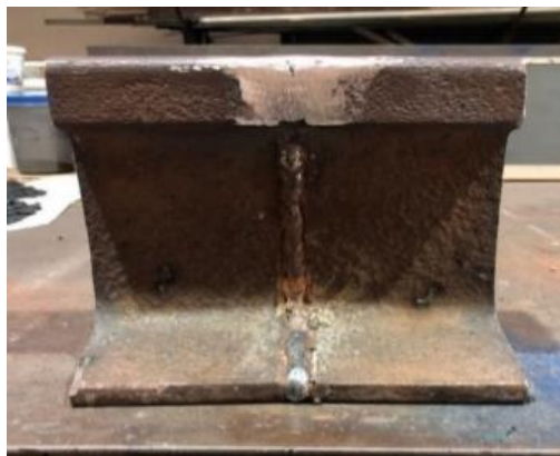
Figura 6. Pasadas de soldadura y esmerilado en probetas.
