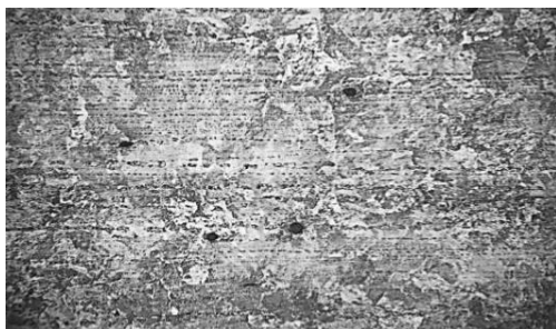
Figura 25. Metalografía tomada del metal base de la muestra AW NIQ MANG, se aprecia cementita en un acero hipereutectoide que se calentó, en matriz perlítica. Ataque químico, nital al 2%. Aumento original X100.
