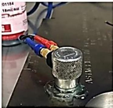
Figura 9. Transductor o palpador recto para equipo de ensayos de UT
