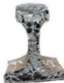
Figura 3. Soldadura aluminotérmica mostrando porosidad severa.
