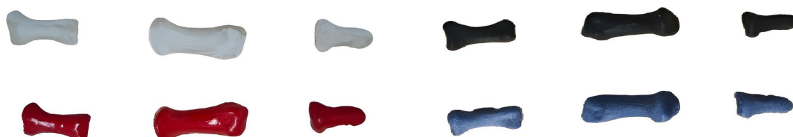
Figura 8. Falanges y metacarpianos impresos en distintos materiales: modelos blancos y rojos (MJ), modelos azules (FFF) y modelos negros (SLA). Fuente: elaboración propia.
