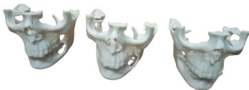
Figura 10. Modelos maxilofaciales impresos con tecnología FFF y material PP+FV. Fuente: elaboración propia.
