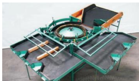
Figura 3. Clasificadora de tomate por tambor giratorio. Fuente: [3].
