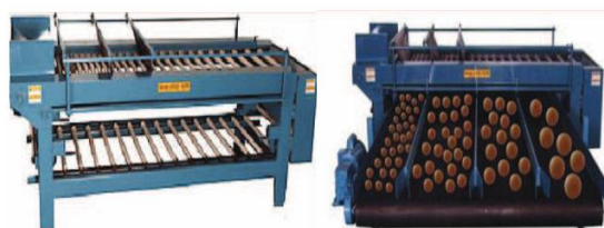
Figura 2. Clasificadora de tomate mecánica con rodillos. Fuente: [3].
