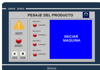
Figura 23. Interfaz Hombre Máquina – pantalla principal HMI. Fuente: elaboración propia.
