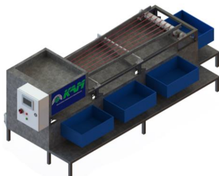
Figura 25. Diseño final de la máquina. Fuente: elaboración propia.
