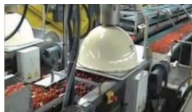
Figura 1. Máquina clasificadora con bandas transportadoras. Fuente: [3].
