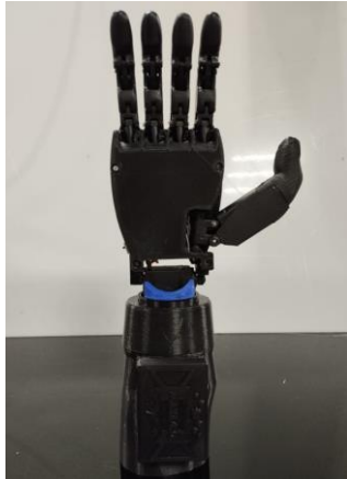
Figura 10. Prótesis impresa y ensamblada Fuente: Elaboración Propia
