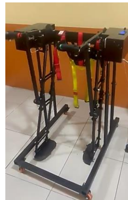
Figura 10. Prototipo de bipedestador construido. Fuente: Elaboración propia
