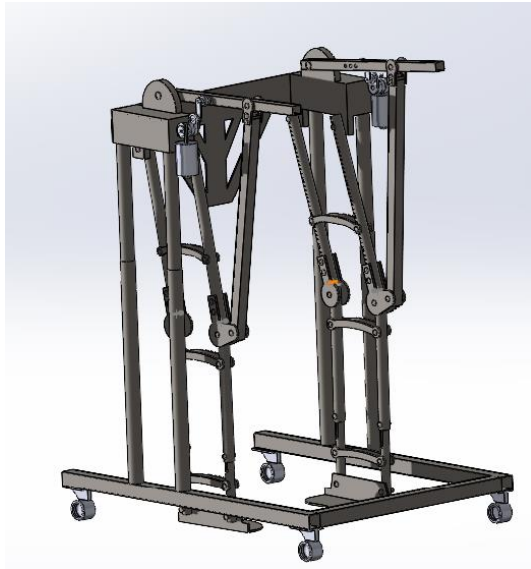
Figura 5. Diseño de concepto del bipedestador. Fuente: Elaboración propia
