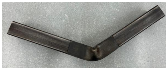
Figura 13. Probeta 11 de tubo rectangular con refuerzos 150 x 40 mm, laterales.
