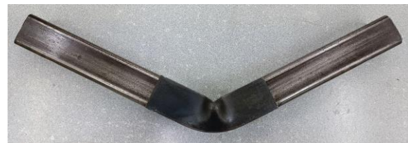
Figura 9. Probeta 5 de tubo cuadrado con refuerzos 150 x 40 mm, laterales.
