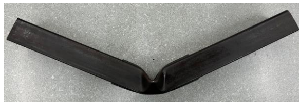
Figura 12. Probeta 12 de tubo rectangular con refuerzos 150 x 40 mm, superior e inferior.
