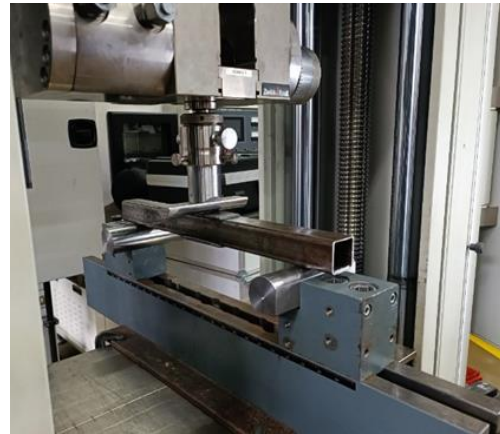
Figura 3. Probeta sobre el puente de flexión, en la máquina de ensayo.
