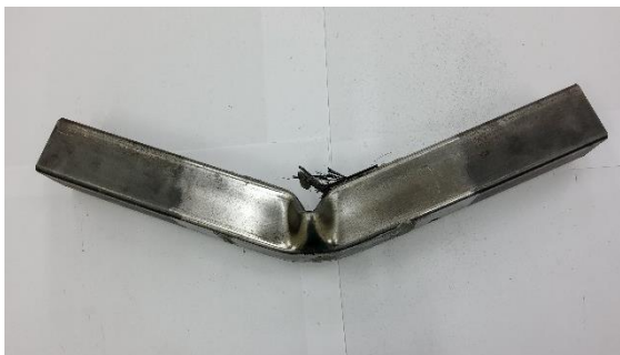
Figura 17. Colapso presentado en el espécimen C15F-02. Fuente: elaboración propia.
