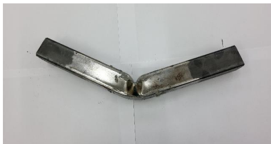
Figura 15. Colapso presentado en el espécimen C10F-03. Fuente: elaboración propia.
