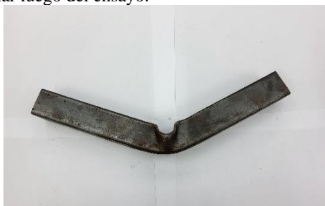
Figura 8. Indentación presentada en el espécimen C-01
