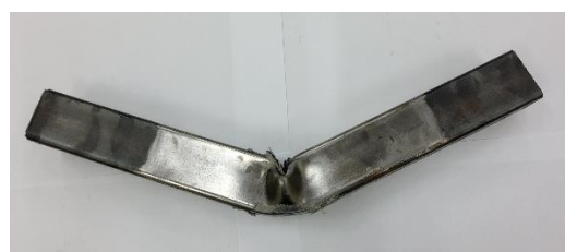
Figura 13. Colapso presentado en el espécimen C05F-01. Fuente: elaboración propia.
