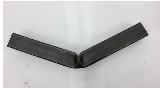
Figura 9. Colapso presentado en el espécimen C-03
