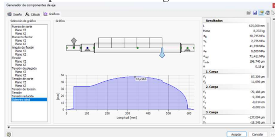
Figura 9. Diseño del eje del rodillo motriz. Fuente: tomado del software Inventor.
