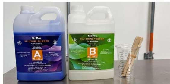
Figura 1. Silicona para la generación de probetas.
