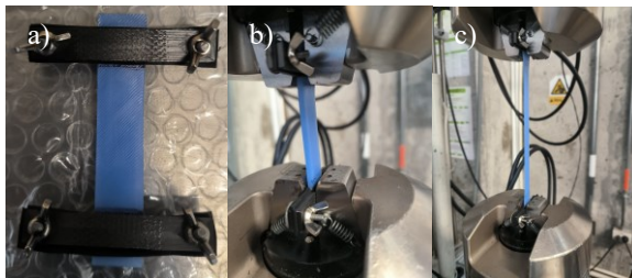
Figura 4. Ensayos de tracción. a) Dispositivo de sujeción, b) Montaje inicial, c) Ensayo en marcha.
