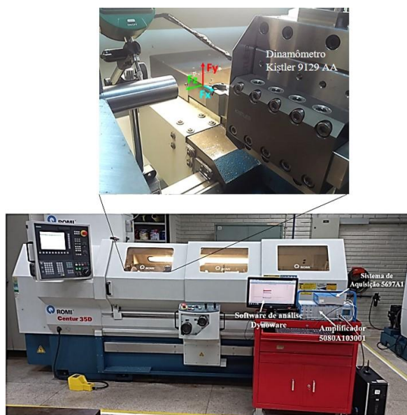
Figura 1. Sistema de medição de força Kistler para o monitoramento das componentes ortogonais da força de usinagem. Fonte: elaboração própria.
