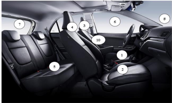
Figura 1: Ubicación de los 10 sensores de temperatura DS18B20 y DHT11 al interior de la cabina del vehículo
