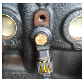
Figura 3. Instalação do sensor de detonação
