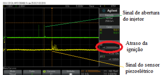
Figure 6. Aparência dos sinais do sensor piezoelétrico, abertura do injetor e a medida do atraso de ignição.
