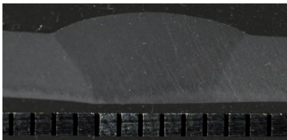
Figura 14. (a) Aspecto superficial y (b) macrografía de la sección transversal del cordón de soldadura con alimentación mecanizada de alambre. Material base AA1100, espesor 3 mm, alambre ER 4043, diámetro de 1,2 mm, velocidad de alambre v_a = 0,8 m/s, alimentación tangencial. Fuente: elaboración propia.
