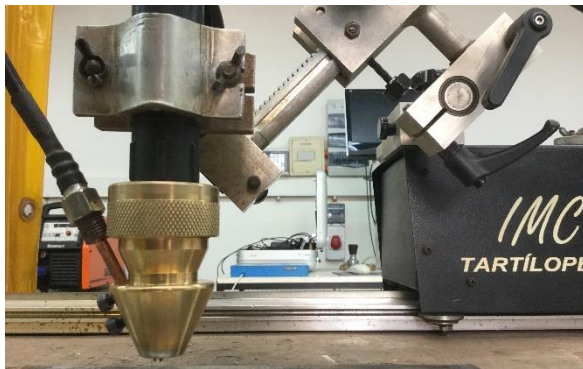
Figura 13. Torcha TIG adaptada para la alimentación mecanizada de alambre. Fuente: elaboración propia
