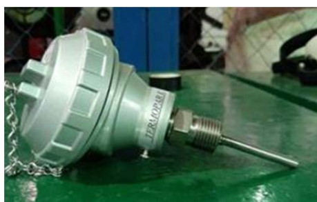
(a) Termopar tipo K
