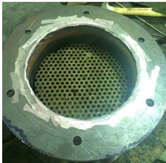
Figure 5. Grelha do gaseificador
