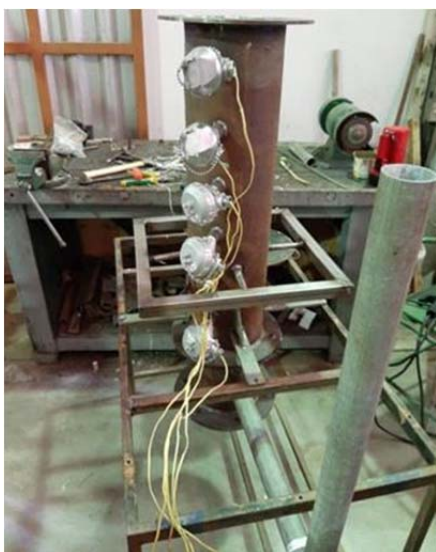
Figure 4. Gaseificador em processo de construção
