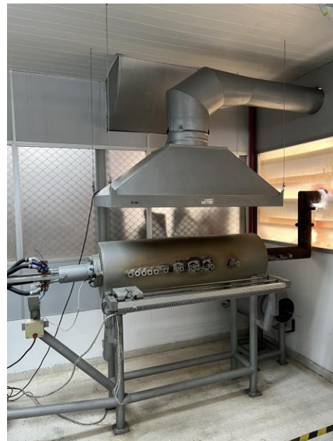
Figura 2. Queimador utilizado para realização dos experimentos. Fonte: Elaboração própria.
