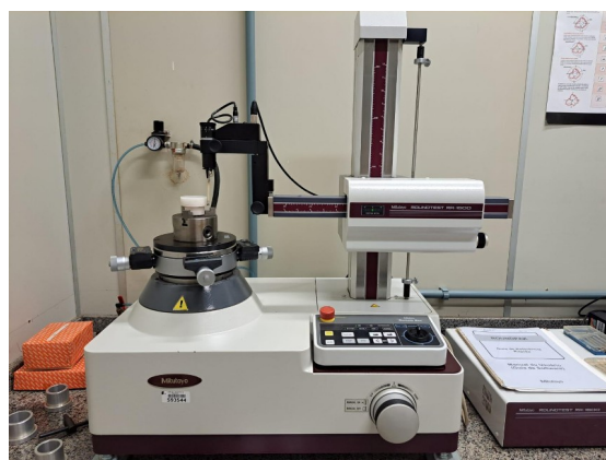
Figura 7. Medição com Circularímetro. Fonte: Elaboração própria.
