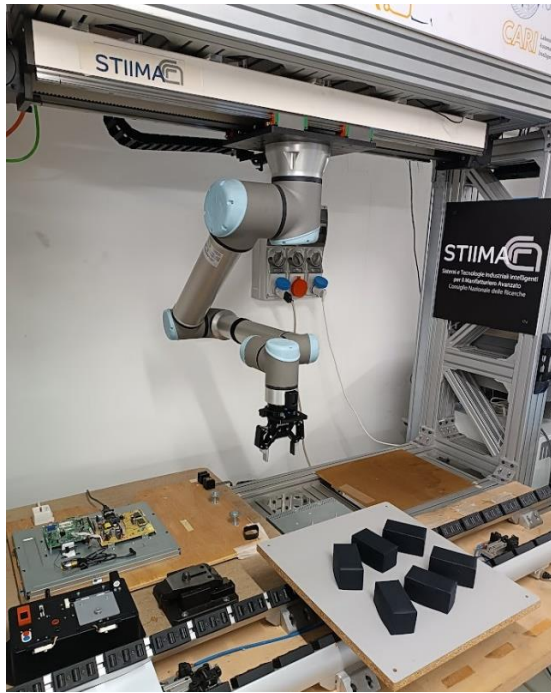
Figura 7. Ejemplo de aplicación del uso del robot UR10e para tareas de pick and place en una célula de trabajo colaborativo.
