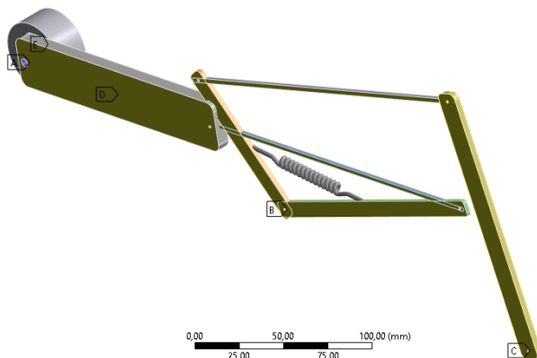
Figura 5. Mecanismo con restricciones y uniones aplicadas en Mechanical para análisis "Modal" (ANSYS 2024)
