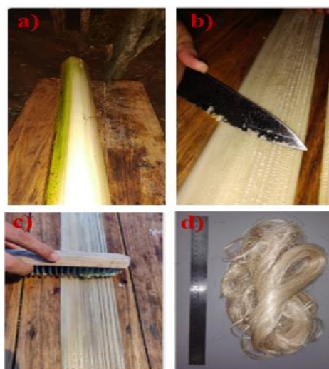
Figura 1. Proceso de extracción de fibras, a) calceta de plátano. b) limpieza de calceta, c) decortinado, d) fibras de plátano.
