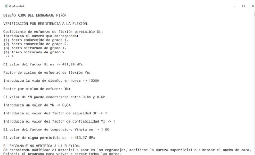
Figura 5. Ejemplo de dimensionado incompleto.
