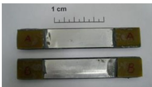
Figura 2: Probeta de Tracción
