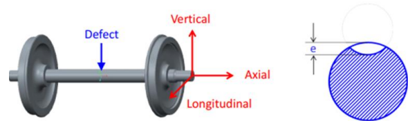
Figura 2. Representación esquemática del eje y de los defectos. Fuente: MAQLAB
