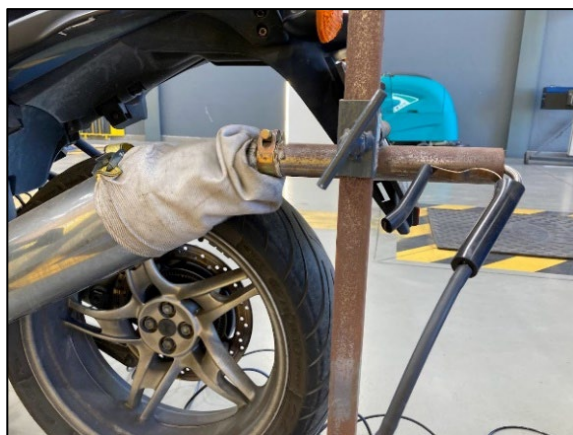
Figura 3. Medición del %CO con el colector diseñado por Itevebasa. Fuente: elaboración propia.
