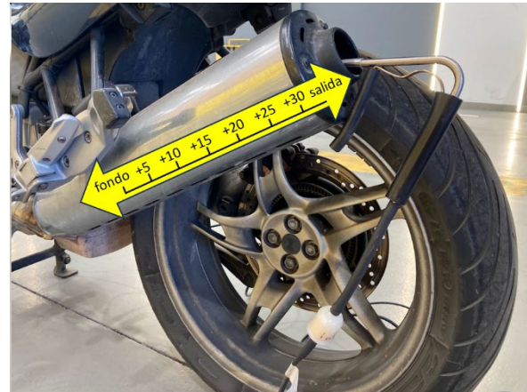
Figura 1. Sonda de medición de %CO en sistema de escape. Fuente: elaboración propia.
