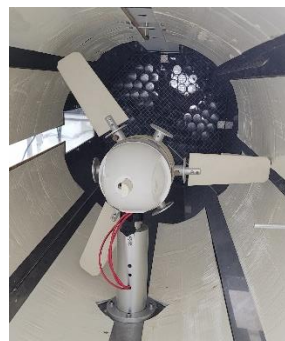
Figura 7. Turbina na configuração de 3 pás montadas em seu rotor, instalada dentro da bancada. Fonte: Autoria própria.
