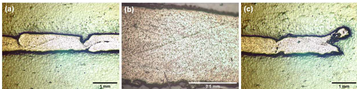
Figura 10. Microscopía óptica de la sección transversal de una muestra de SLS de 2 capas: (a) Parte central de la sección; (b) Imagen detallada de la parte central; (c) Lateral de la sección.
