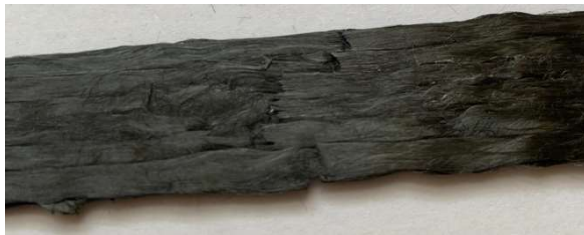
Figura 8. Falta de alineamiento en los cortes de una probeta bioinspirada en la que los cortes de cada capa debían estar alineados.
