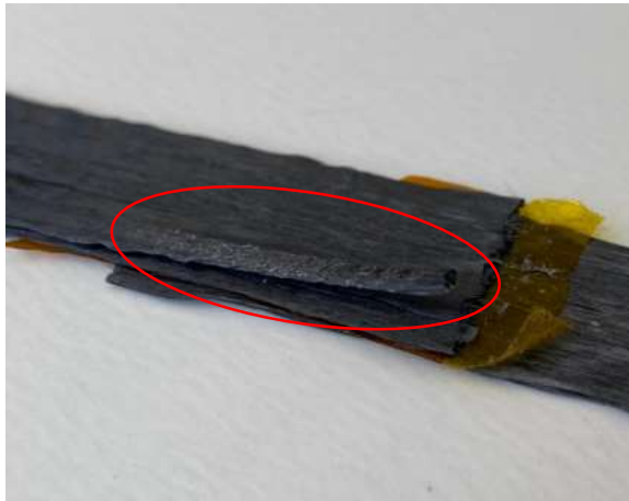
Figura 7. Línea de la segunda capa no adherida en su extremo y curvada como consecuencia del enfriamiento sufrido.
