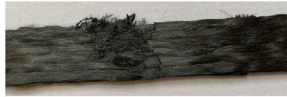
Figura 9. Mala calidad superficial en la zona de los cortes.
