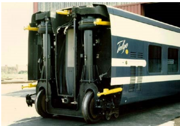
Figura 8. Rodal del Talgo Pendular. Fuente: archivo de Talgo
