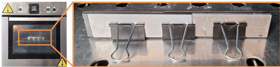
Figura 3. Horno empleado junto con detalle en su interior de la probeta SLJ y su utillaje. Fuente: elaboración propia.
