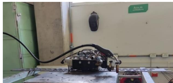
Figura 1. Estación mecanizada de soldadura para aplicación de procesos GMAW y FCAW.
