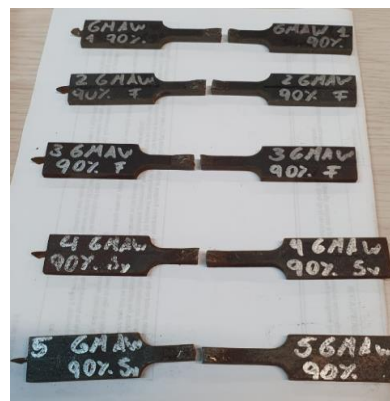
Figura 9. Conjunto de probetas soldadas con proceso GMAW y falladas bajo ensayo de fatiga.
