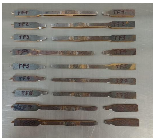
Figura 7. Conjunto de probetas soldadas con proceso FCAW y falladas bajo ensayo de tracción.
