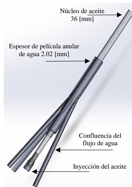
Figura 3. Vista general de la boquilla de inyección utilizada para inducir el patrón de flujo anular en un flujo ascendente aceite-agua en una tubería vertical. Fuente: elaboración propia.
