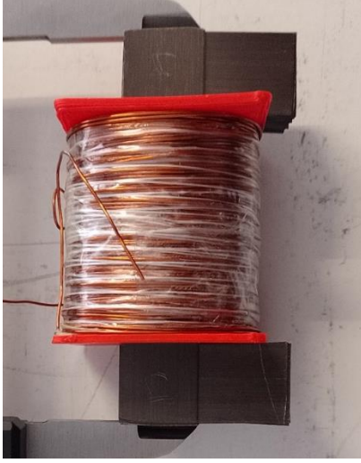
Figura 5. Electroimán utilizado en el prototipo del AMB.
