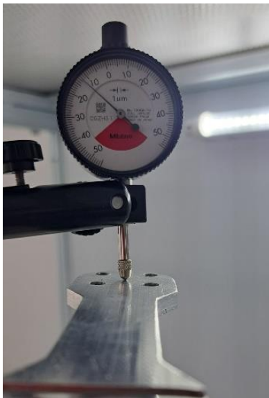
Figura 10. Indicador de carátula montado en el efector terminal.
