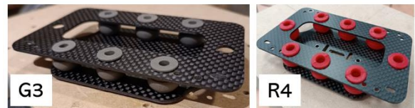
Figura 3. A la izquierda: Configuración N°3 con aisladores G. A la derecha: Configuración N°4 con aisladores R. Fuente: elaboración propia.
