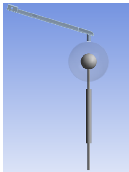
Figura 8: Sistema masa resorte-amortiguador en módulo de ANSYS Rigid Dynamics. Fuente: elaboración propia.
