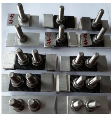
Figura 6. Provetes do segundo estudo com compensadores de espessura colocados. Fonte: elaboração própria.
