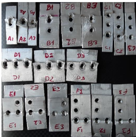
Figura 11. Estado em que os provetes do primeiro estudo ficaram após os ensaios de tração. Fonte: elaboração própria.
