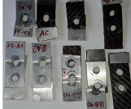
Figura 12. Estado em que os provetes do segundo estudo ficaram após os ensaios de tração. Fonte: elaboração própria.
