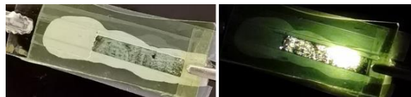
Figura 10. Imagen del OLED fabricado con la técnica doctor blade.
