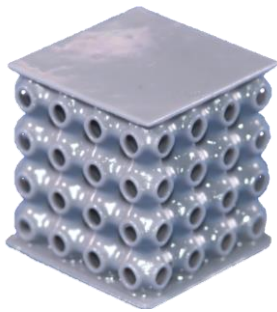
Figura 9. Probeta de compresión Schwarz P, t=0.68mm . Fuente: elaboración propia.
