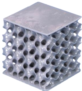
Figura 10. Probeta de compresión Gyroid, t=0.68mm . Fuente: elaboración propia.
