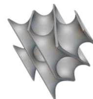
Figura 4. Celda unitaria Diamond, elaborada en nTop™. Fuente: elaboración propia.
