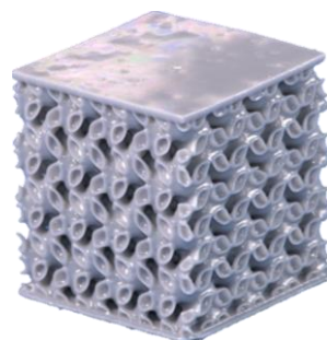
Figura 13. Probeta de compresión Lidinoid, t=0.68mm . Fuente: elaboración propia.
