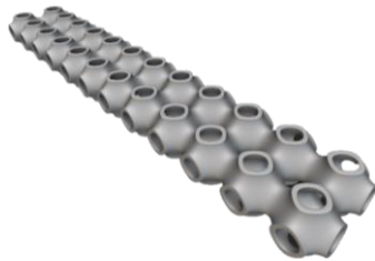
Figura 10. Probeta de impacto Charpy, elaborada en nTop™, celda Schwarz P. Fuente: elaboración propia.
