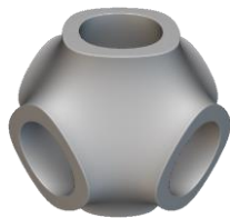
Figura 2. Celda unitaria Schwarz P, elaborada en nTop™. Fuente: elaboración propia.
