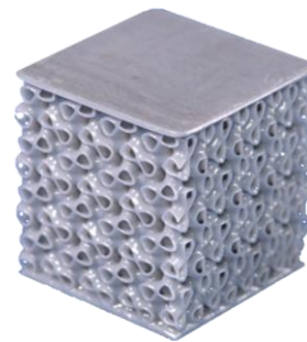
Figura 12. Probeta de compresión Split P, t=0.68mm . Fuente: elaboración propia.
